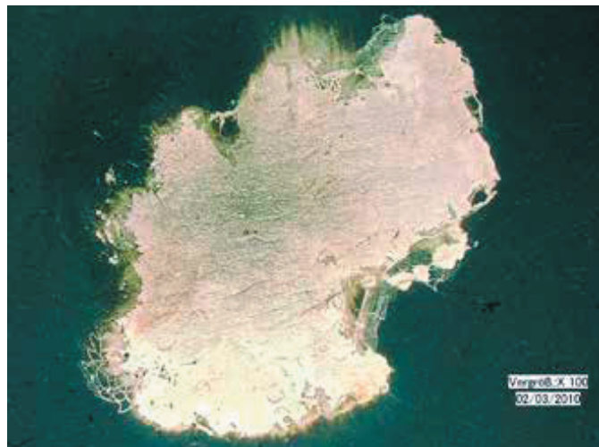
Selbstheilungsprozess in einer typischen metallisierten Folie
